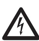
Verletzungsgefahr! Warnung vor gefährlicher elektrischer Spannung.
