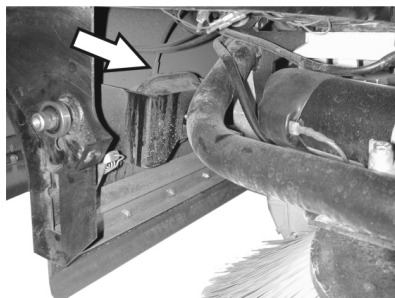
Элемент подключения шланга для мембранного механизма вакуумного регулятора опускания боковых щеток.
