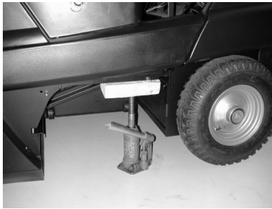
Punto di appoggio del cric (ruote posteriori)
