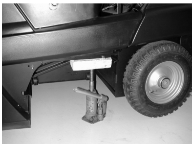
Bod uchytenia pre zdvihák vozidla (zadné koleso)
