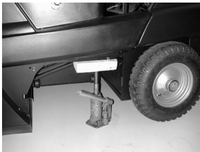
Kocsiemelő felfektetési pontja (hátsó kerekeknél)
