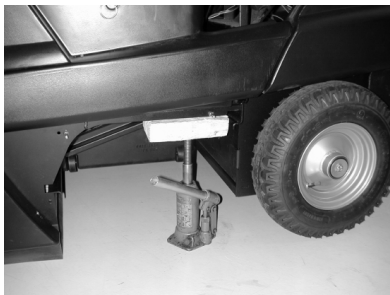
Punkt mocowania lewarka (do tylnych kół)
