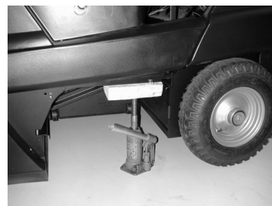
Точка установки домкрата (задние колеса)
