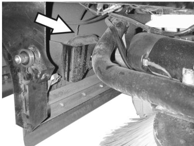
Vaakuummoduli ja külgmiste harjade langetussüsteemi voolikuliitmik
