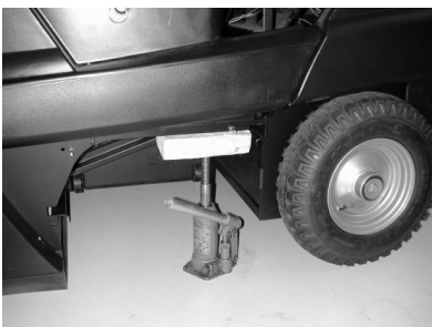
Aufnahmepunkt für Wagenheber (Hinterräder)
